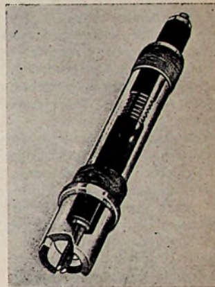
Fig. 2. Eén der spoelstellen voor het drukknopsysteem van de Sachsenwerk Olympia 405W.
